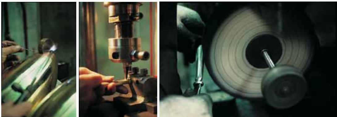
Ercuis 工艺：焊接、刀具制造、打磨勺柄
